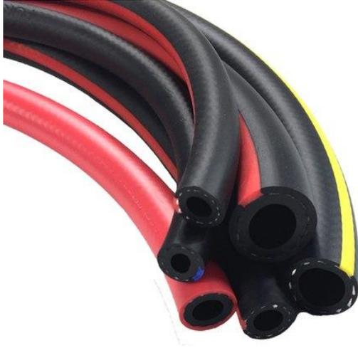
تستخدم حبيبات TPE التي تركيب من PVC و NBR لزيادة الخاصية المرنة للخرطوم. هذه الخرطوم لها مرونة ومثانة أكثر مقارنة مع خرطوم PVC. خرطوم TPE لها مرحلة مطاطية تؤدي إلى زيادة خصائصها الميكانيكية مقارنة مع الخرطوم الأخرى. هذه الخرطوم عادة تستخدم في الاستخدامات الصناعية التي تكون تحت الضغط الوظيفي العالي.
